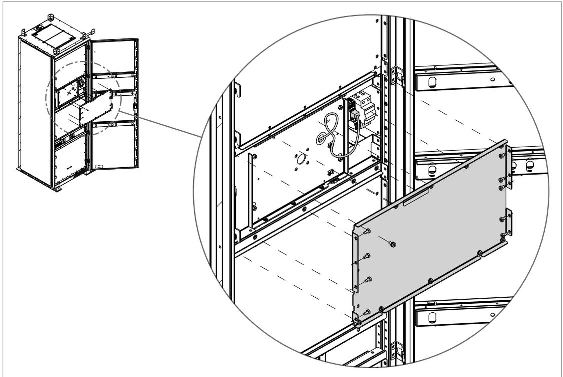
5. Disconnect the fan wiring.
