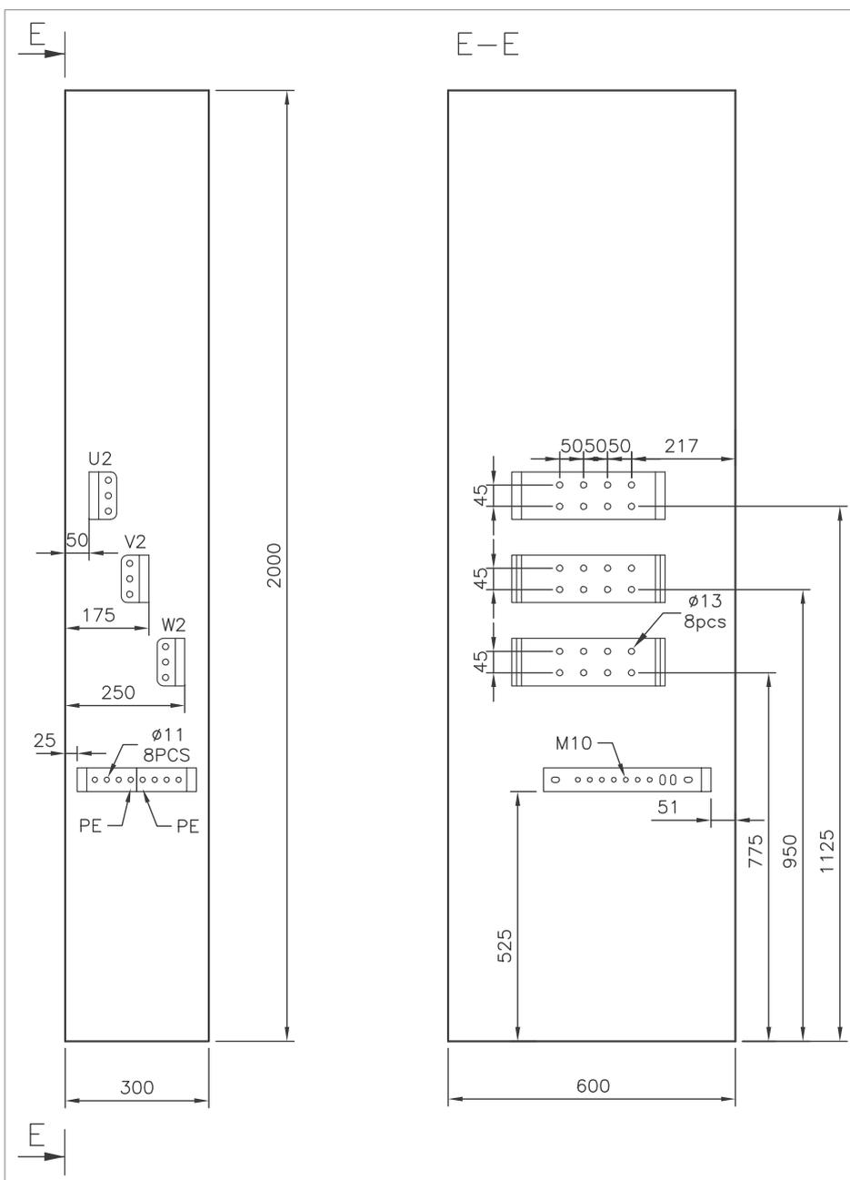
**Cubicle width 400 mm, bottom cable exit**
