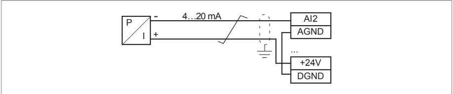
Di seguito è riportato un esempio di sensore/trasmittitore a 3 fili alimentato dall'uscita di tensione ausiliaria del convertitore. Il sensore è alimentato attraverso la sua uscita di corrente e il convertitore fornisce la tensione di alimentazione (+24 Vcc). Pertanto il segnale di uscita deve essere 4...20 mA, non 0...20 mA.
