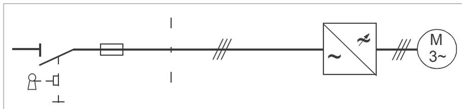
Selezionare i fusibili e gli interruttori automatici in base alle normative locali per la protezione del cavo di ingresso. Selezionare i fusibili e gli interruttori automatici per il convertitore di frequenza seguendo le istruzioni contenute nei dati tecnici. I fusibili e gli interruttori automatici di protezione del convertitore limitano i danni al convertitore ed evitano danni alle apparecchiature adiacenti in caso di cortocircuito all'interno del convertitore.
