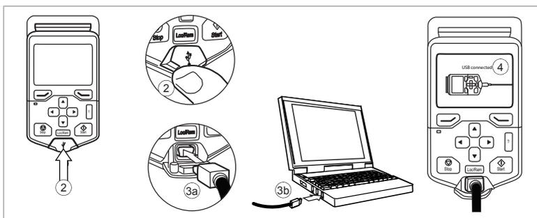
**Nota:** Per il convertitore IP66 (UL tipo 4X), la connessione USB sul pannello non è accessibile quando il coperchio è in posizione. Utilizzate la funzionalità Bluetooth per risolvere i problemi del convertitore utilizzando l'app DriveTune dal telefono.
