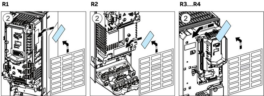
3. Rimuovere i gommini dei cavi di alimentazione e motore e del cavo della resistenza di frenatura, se utilizzato.
