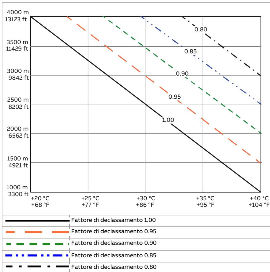
**Nota:** Verificare le limitazioni di compatibilità della rete di alimentazione ad altitudini superiori a 2000 m (6562 ft); vedere [Altitudine del luogo di installazione](#) (pag. 300). Verificare anche i limiti PELV sui morsetti delle uscite relè ad altitudini superiori a 2000 m (6562 ft); vedere le sezioni [Aree di isolamento](#) (pag. 186) per i telai R1...R5 e [Aree di isolamento](#) (pag. 190) per i telai R6...R9.
