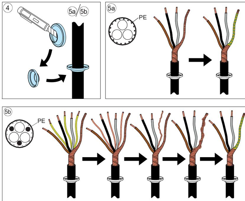
6. Far passare il cavo attraverso il foro della piastra inferiore e inserire il gommino nel foro.
