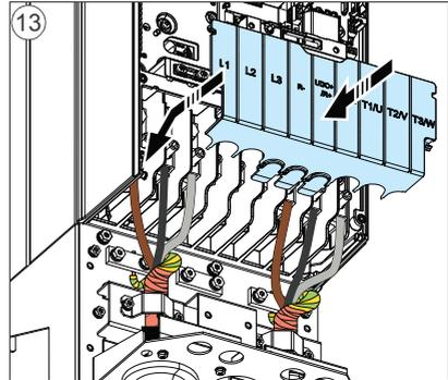
15. Mettere a terra la schermatura del cavo del motore sul lato motore. Per ridurre al minimo le interferenze da radiofrequenza, mettere a terra la schermatura del cavo motore a 360° in corrispondenza dell'ingresso cavi della morsettiera del motore.
