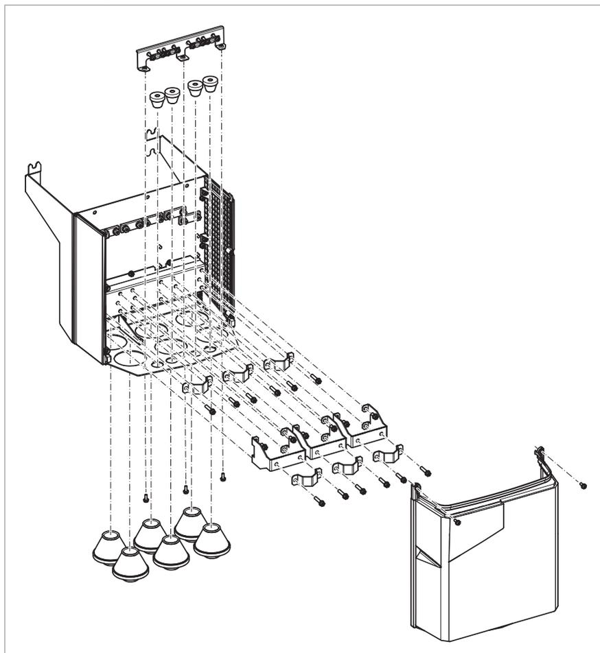
■ **Cassetta cavi per telaio R9 (IP21, UL tipo 1)**
