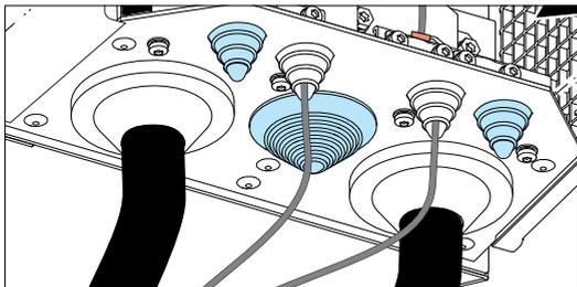
**IP66 (UL tipo 4X):** tappare i fori inutilizzati con un tappo con IP66 (UL tipo 4X) o superiore e serrare saldamente.
