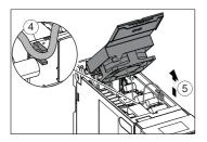
6. Free the fan clips and remove the fan from the fan cover.
