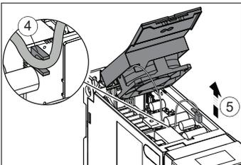
6. Free the fan clips and remove the fan from the fan cover.
