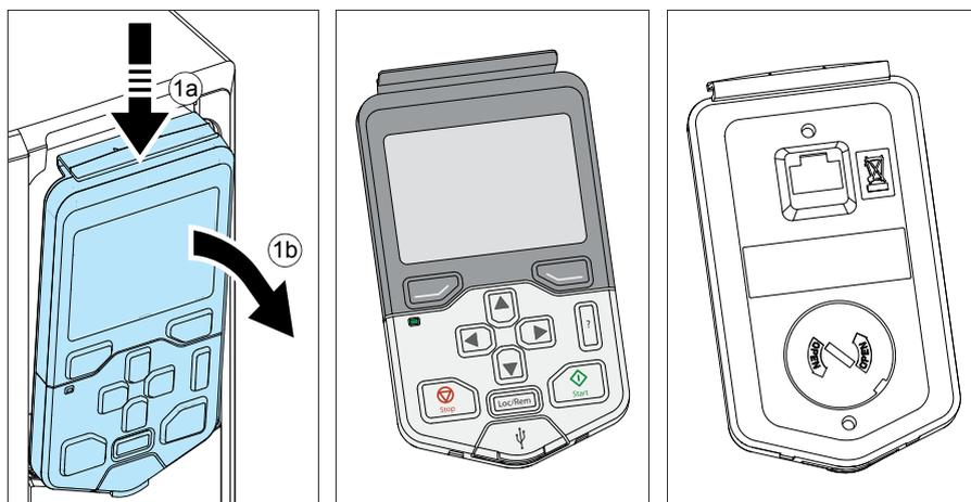
2. Per rimuovere la batteria, ruotare il portabatteria posto sul retro del pannello di controllo utilizzando una moneta.
