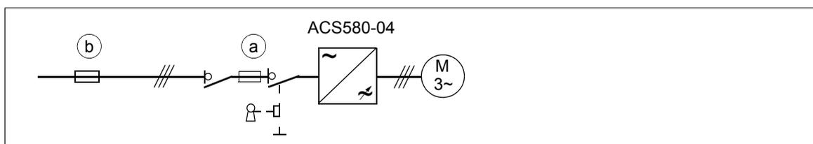
Dimensionare i fusibili o l'interruttore automatico in corrispondenza della scheda di distribuzione in base alle normative locali per la protezione del cavo di ingresso. Selezionare i fusibili per il convertitore di frequenza seguendo le istruzioni contenute nel capitolo [Dati tecnici](#). I fusibili di protezione del convertitore limitano i danni al convertitore ed evitano danni alle apparecchiature adiacenti in caso di cortocircuito all'interno del convertitore.
