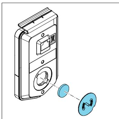
3. Sostituire con batterie di tipo CR2032. Smaltire la vecchia batteria secondo le normative ecologiche locali.
