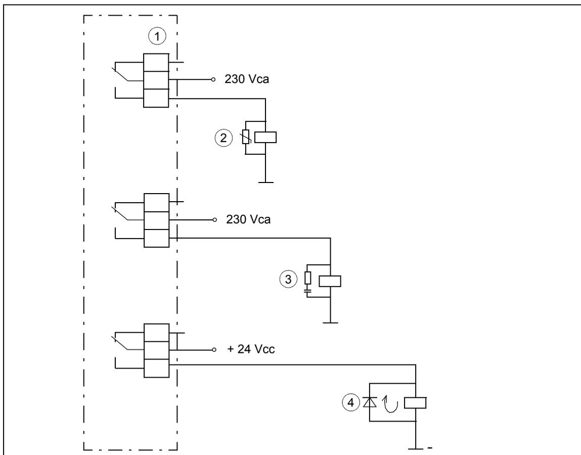
1) Uscite relè; 2) Varistore; 3) Filtro RC; 4) Diodo
