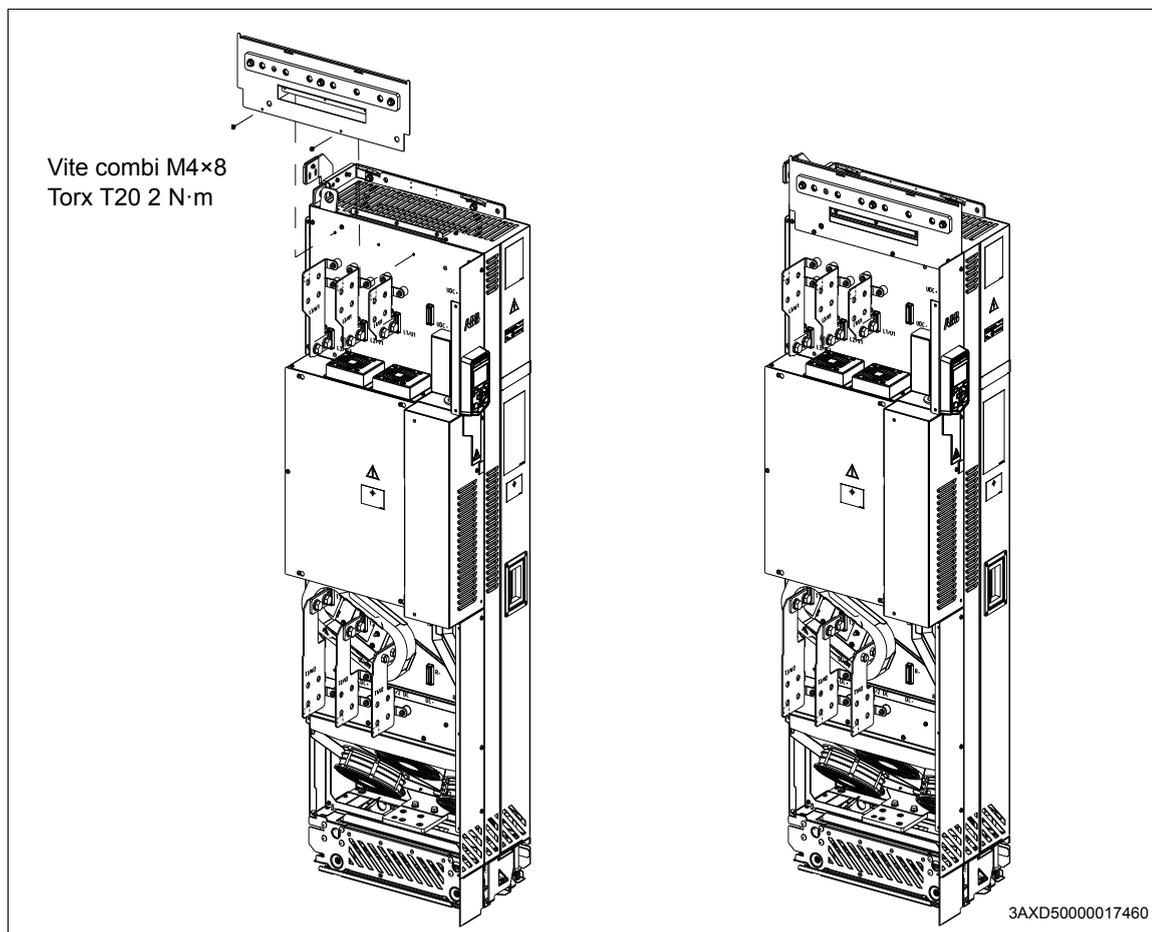
■ **Modulo convertitore senza morsetti di collegamento dei cavi di uscita (opzione +0H371)**
