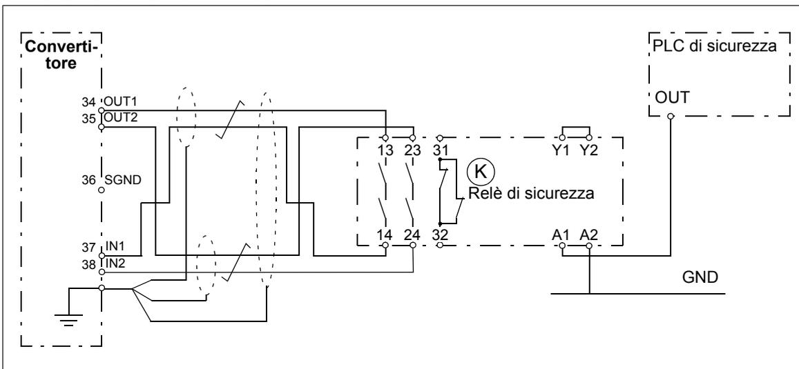
Di seguito è illustrato un esempio di collegamento della funzione Safe Torque Off con alimentazione esterna +24 Vcc.
