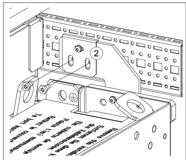
Vite autofilettante M6x12 Torx T30 (esa.) 9 N·m
