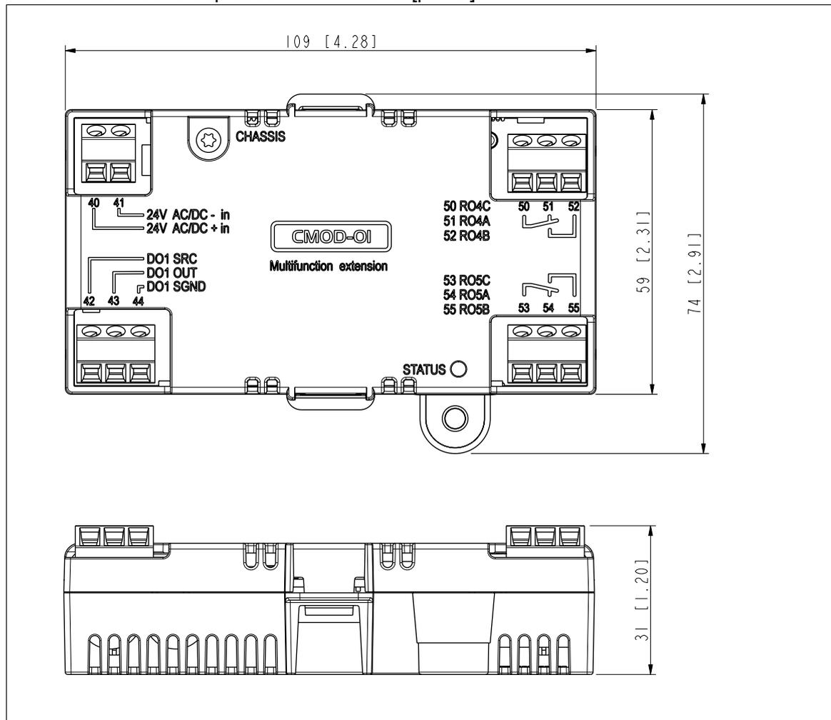
**Installazione:** in uno slot opzionale sull'unità di controllo del convertitore di frequenza.
