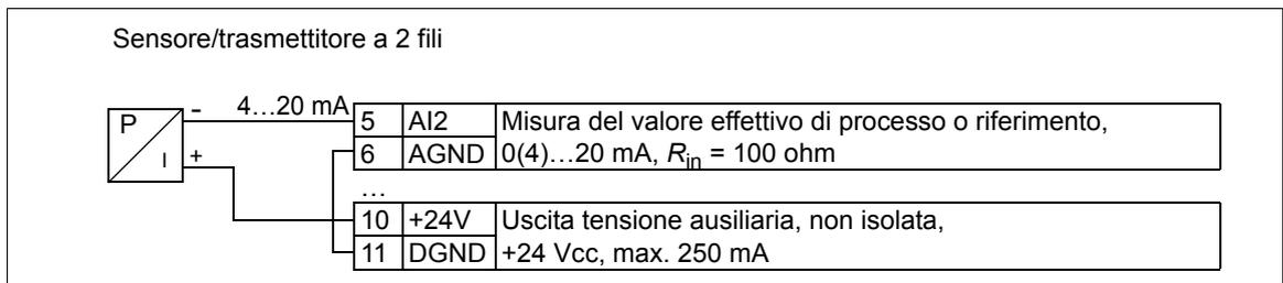
**Nota:** il sensore è alimentato attraverso la sua uscita di corrente e il convertitore fornisce la tensione di alimentazione (+24 Vcc). Pertanto il segnale di uscita deve essere 4...20 mA, non 0...20 mA.
