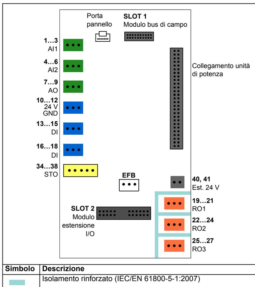
I morsetti sulla scheda soddisfano i requisiti di protezione da minima tensione (PELV, Protective Extra Low Voltage) secondo EN 50178: è presente un isolamento rinforzato tra i morsetti dell'utente che accettano solo tensioni ELV e i morsetti che accettano tensioni superiori (uscite relè).
