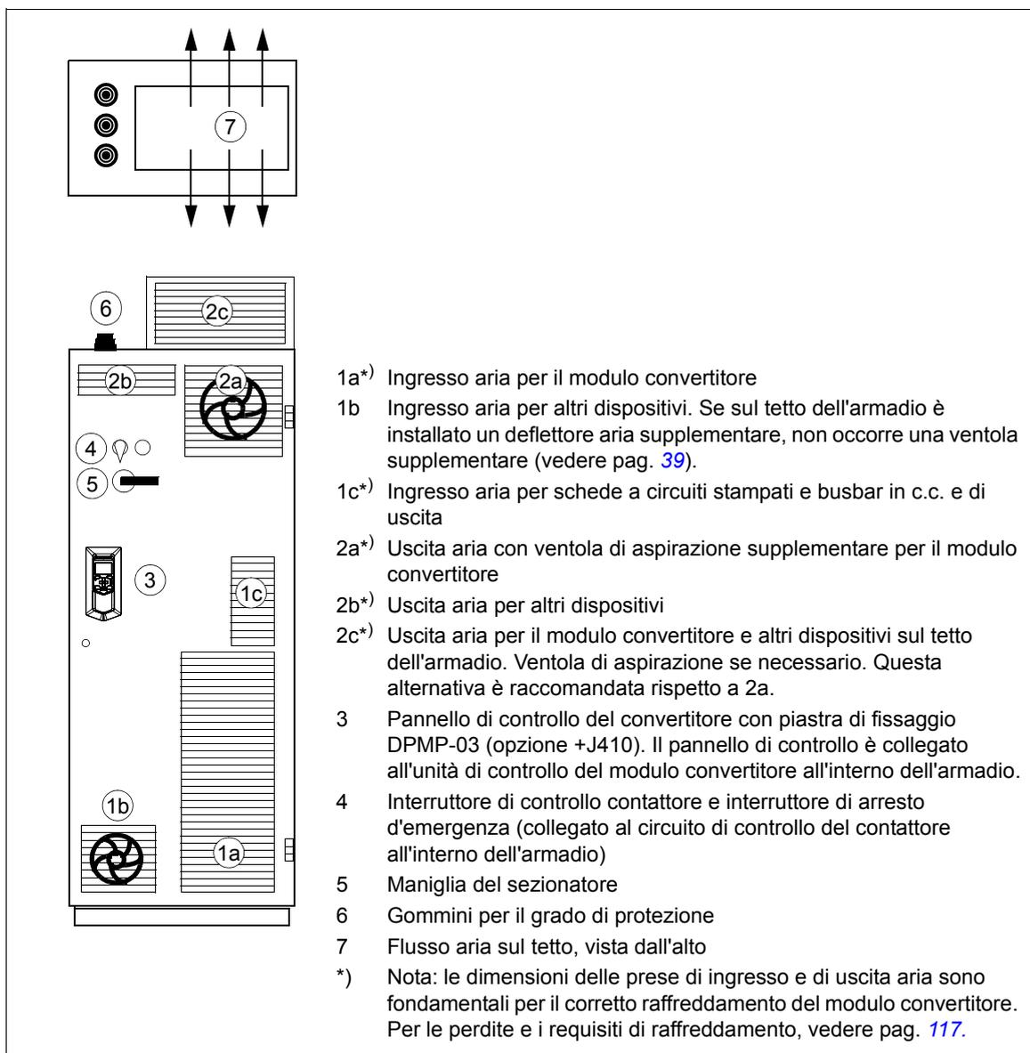
■ Esempio di layout, sportello aperto (modulo convertitore in configurazione standard)
