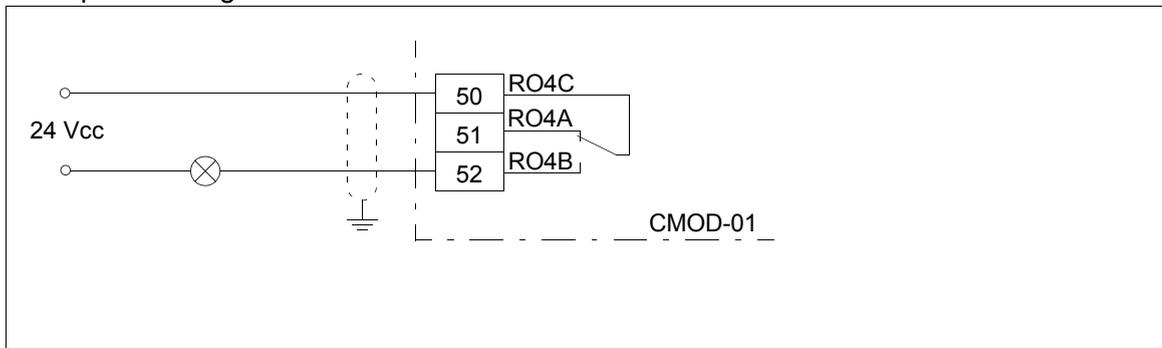
Esempio di collegamento delle uscite digitali
