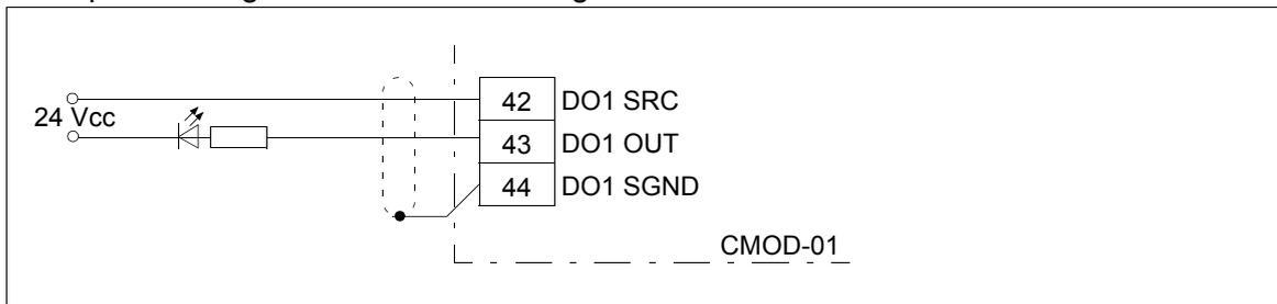
Esempio di collegamento delle uscite di frequenza
