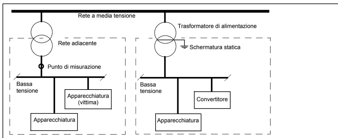
2. Per l'installazione è stato predisposto un piano EMC di prevenzione dei disturbi. È possibile richiedere un modello al rappresentante ABB locale.
