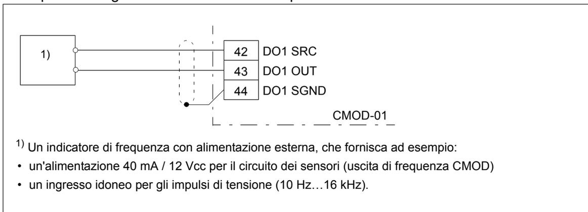
Esempio di collegamento dell'alimentazione esterna
