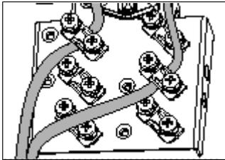
7. Collegare i conduttori ai corrispondenti morsetti remotabili dell'unità di controllo. Vedere la sezione [Schema di collegamento degli I/O di default \(macro ABB Standard\)](#) a pag. 80 per i collegamenti di I/O di default della macro ABB Standard. Per le altre macro, vedere il Manuale firmware. Utilizzare guaina termorestringente o nastro isolante per avvolgere eventuali filamenti che fuoriescono. Serrare le viti per fissare il collegamento.
