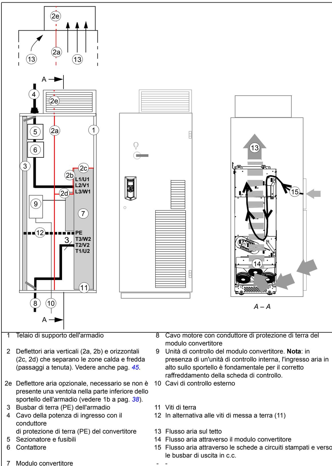
Nota 1: anche le schermature dei cavi di potenza possono essere messe a terra con i morsetti di terra del modulo convertitore.
