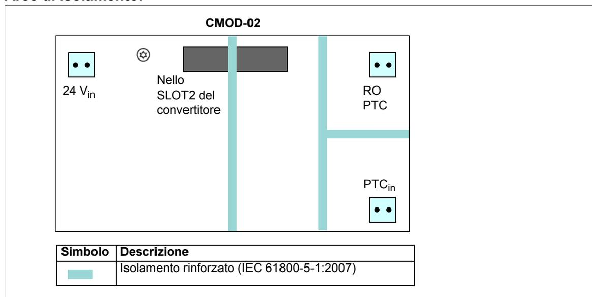
**Collegamento del termistore del motore (60...61):**
