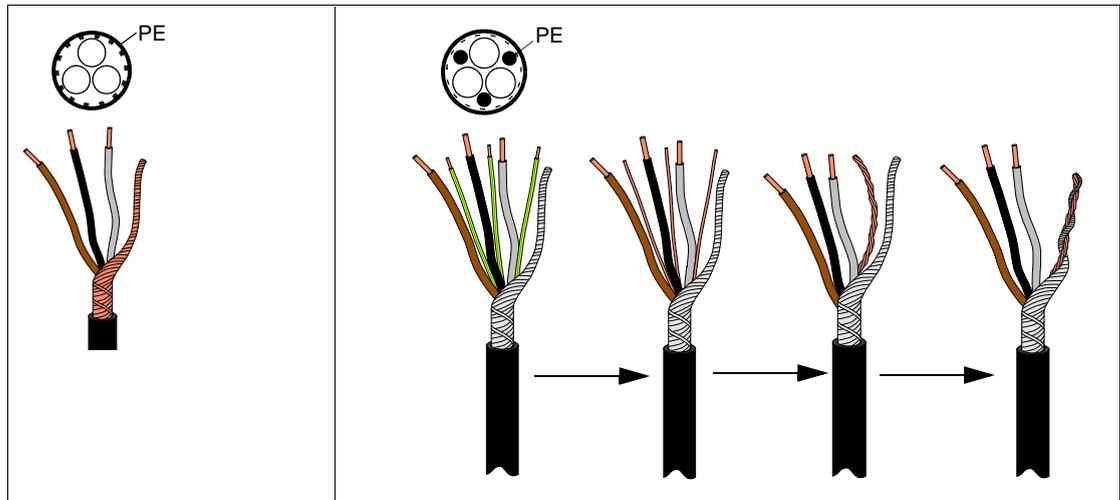
3. Raccordez les conducteurs de phase des câbles moteur aux bornes T1/U2, T2/V2 et T3/W2 du module variateur. Pour les couples de serrage, cf. page 117.
