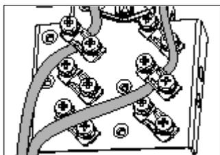
7. Raccordez les conducteurs aux bornes débrochables correspondantes de l'unité de commande. Cf. section [Schéma de raccordement des signaux d'E/S \(préréglages, Standard ABB\)](#) page 80. Pour les autres macroprogrammes, cf. manuel d'exploitation. Rassemblez les éventuels brins en désordre dans une gaine rétractable ou avec du ruban isolant. Serrez les vis pour sécuriser le raccordement.
