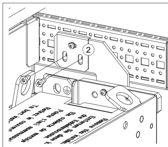
Vis autotaraudeuse M6x12 Torx T30 (Hex) 9 N·m
