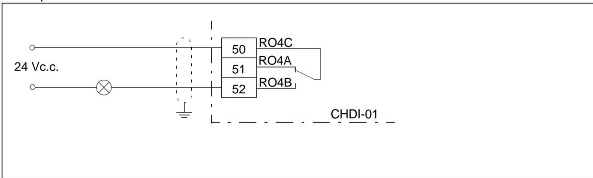
Exemple de raccordement d'une entrée logique
