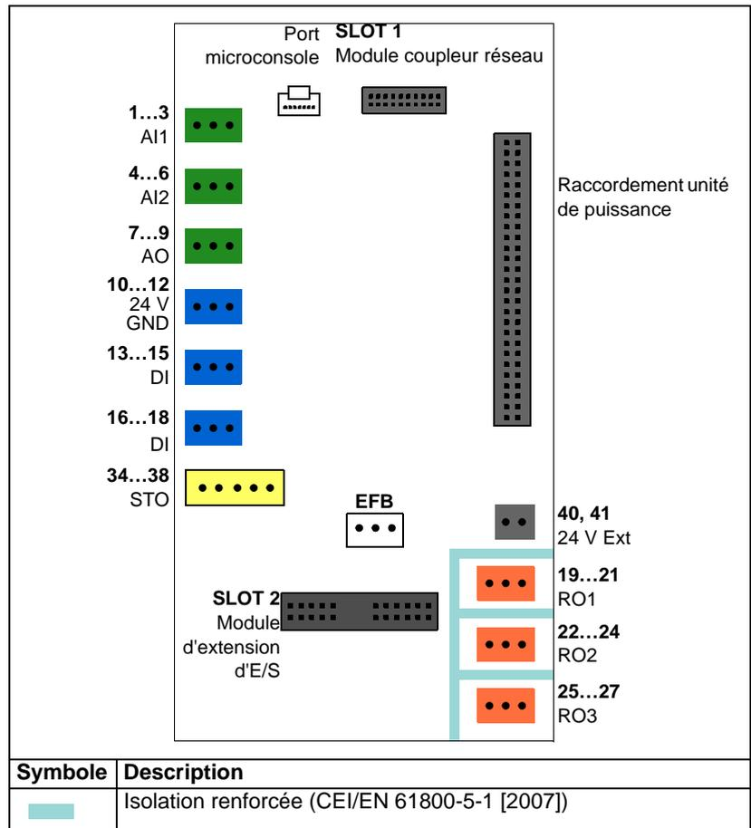
Les bornes de la carte de commande satisfont les exigences de très basse tension de protection (PELV) selon EN 50178. Une isolation renforcée est installée entre les bornes utilisateur, qui peuvent uniquement recevoir des très basses tensions (ELV), et les bornes tolérant des tensions plus élevées (sorties relais).
