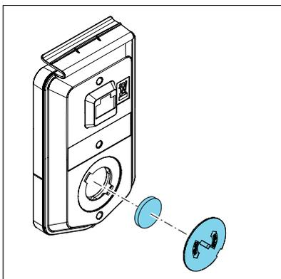
3. Remplacez par une batterie de type CR2032. Mettez au rebut la batterie usagée conformément à la législation et à la réglementation en vigueur.
