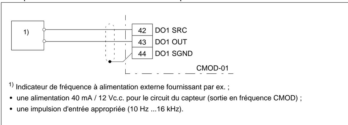
Exemple de raccordement d'une alimentation externe
