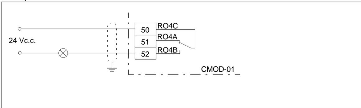
Exemple de raccordement d'une sortie logique
