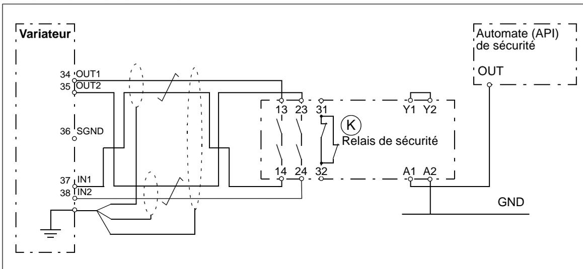
Le schéma ci-dessous illustre un exemple de câblage de la fonction STO avec une alimentation externe +24 Vc.c.
