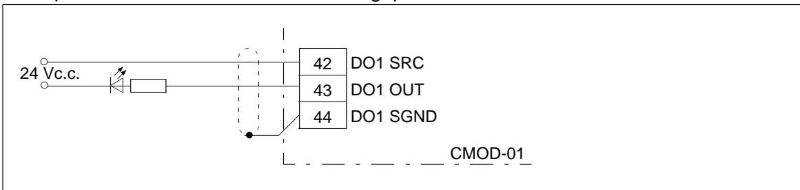
Exemple de raccordement d'une sortie en fréquence
