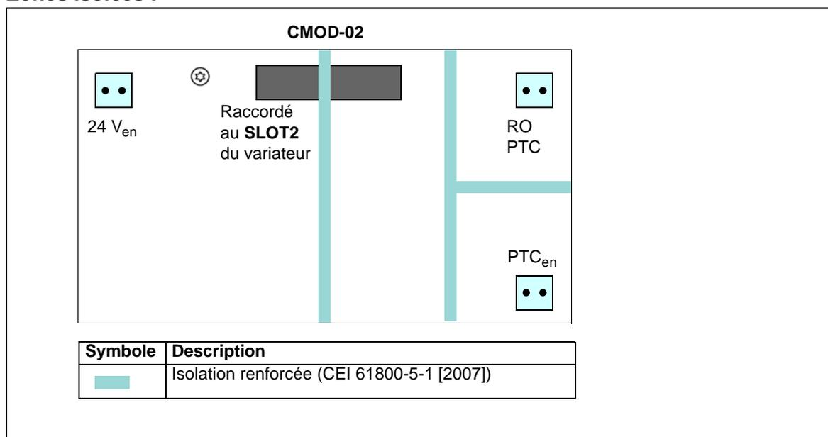
**Raccordement thermistance moteur (60...61) :**
