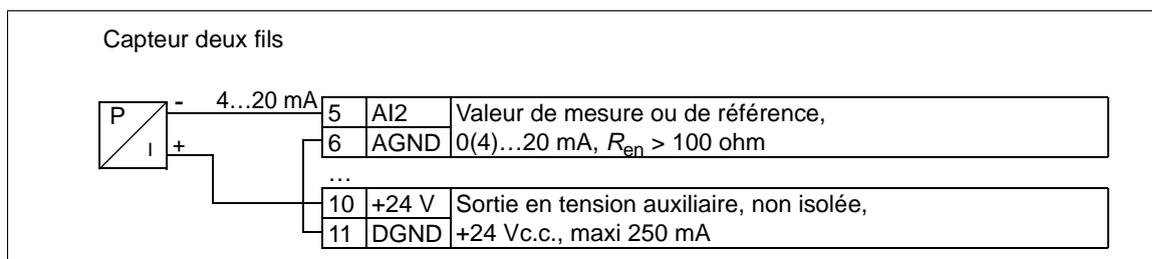
**N.B. :** Le capteur est alimenté par sa sortie en courant et le variateur fournit la tension d'alimentation (+24 Vc.c.). Par conséquent, le signal de sortie doit être 4...20 mA, non 0...20 mA.
