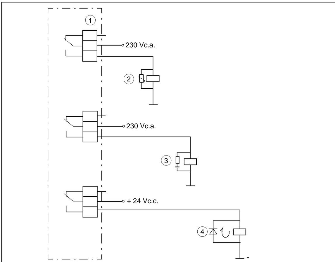
1) Sorties relais ; 2) Varistance ; 3) Filtre RC ; 4) Diode
