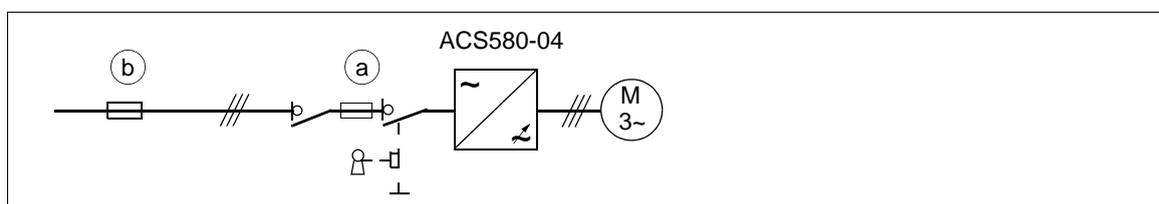
Les fusibles ou le disjoncteur du tableau de distribution doivent être dimensionnés en fonction de la réglementation pour la protection des câbles réseau en vigueur. Les fusibles du variateur doivent être sélectionnés comme spécifié au chapitre [Caractéristiques techniques](#). Les fusibles de protection du variateur préviennent la dégradation du variateur et des équipements avoisinants en cas de court-circuit dans le variateur.
