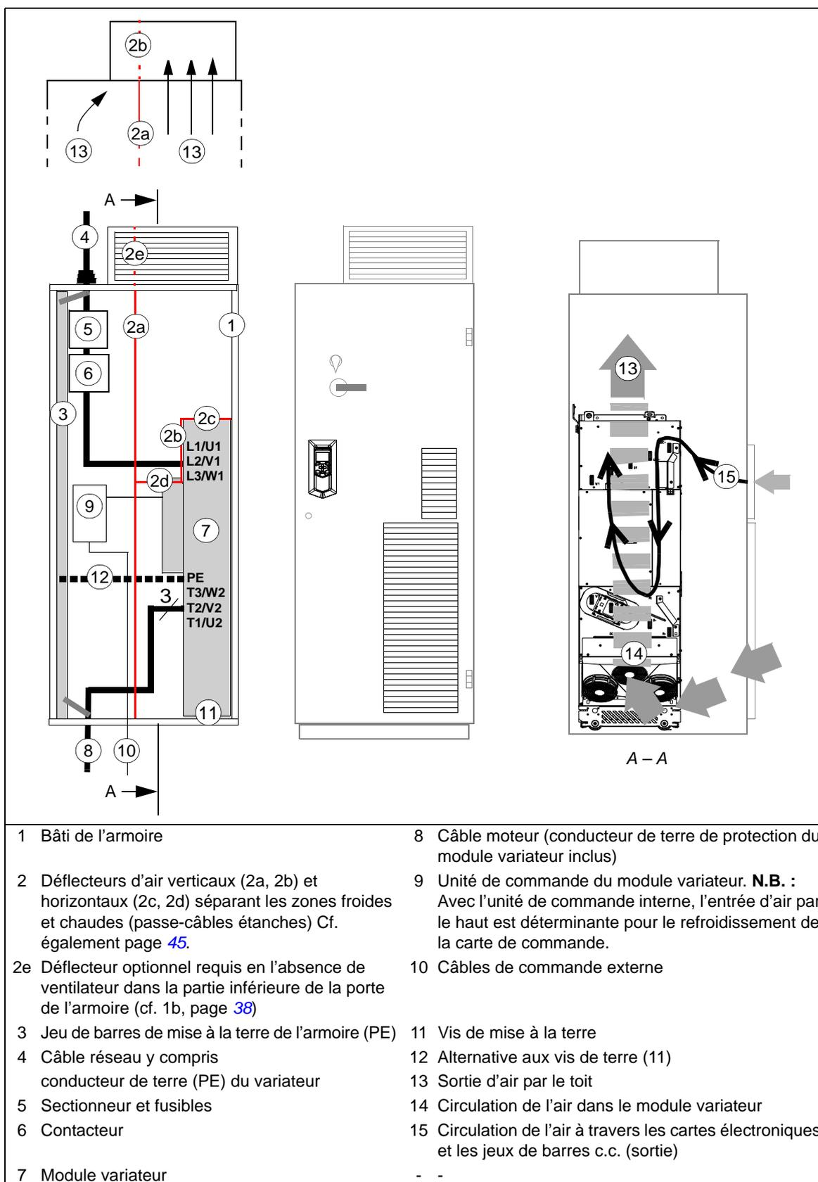
**N.B. 1 :** Le blindage des câbles de puissance peut aussi être raccordé aux bornes de terre du module variateur.
