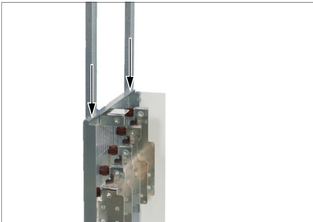
6. Die Erdungsschiene am Ausgangs-Kabelanschlussblech (Option +H381) anbringen. Nachfolgend ist die Ansicht von hinten dargestellt.
