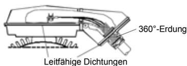
oder das Kabel durch Verdrillen des Schirms erden, so dass der abgeplattete Schirm breiter als 1/5 seiner Länge ist.
