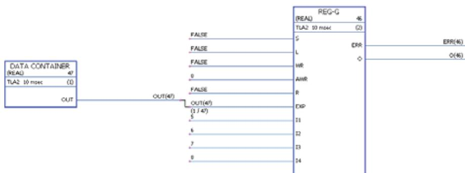
Im Diagramm enthält der Baustein DATA CONTAINER ein Array mit Werten [1,2,3,4]. Bei Start ist das Ausgangsarray = [0,0,0,0,0,0,0]. Wenn WR auf 1 und wieder auf 0 wechselt, bedeutet der AWR-Wert von 0, dass nur EXP in das Ausgangsarray übertragen wird, das jetzt folgenden Inhalt hat [1,2,3,4,0,0,0]. Danach wechselt AWR auf 3, was bedeutet, dass die Eingänge EXP und I3 zum Ausgang übertragen werden. Nach einer WR-Schaltung enthält das Ausgangsarray dann [1,2,3,4,0,0,7,0].
