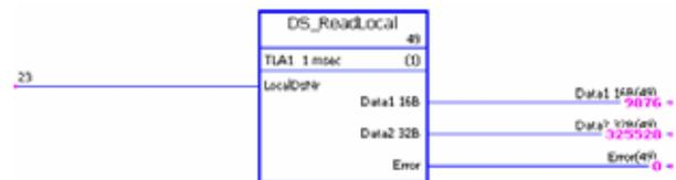
1. Der Master sendet eine Konstante (9876) sowie den Wert des Meldungs Zählers an alle Follower. Die Daten werden eingepflegt und vom Master-Datensatz 19 zum Follower-Datensatz 23 gesendet.
