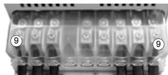
*Taille R6 : Installation de la borne à vis (câbles de 95 à 210 mm<sup>2</sup> [3/0 à 400 MCM])*
