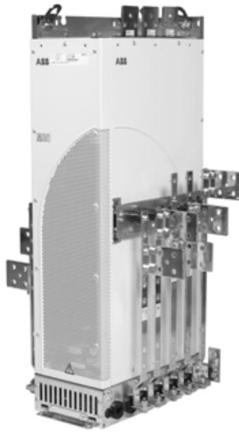
*Stromschienen für Motor- und Bremswiderstandsanschluss auf der rechten Seite des Moduls und Stromschienen für DC-Anschluss auf der linken Seite*
