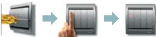
Ponga el detector de movimiento de Wireless (9504) en modo P (Programación). Si se ha asociado correctamente, después de 5 segundos el LED de la tecla con conector parpadeará 3 veces en verde.
