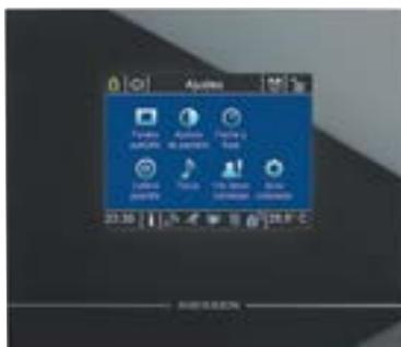
Además el instalador dispone también (ver figura) de un botón/icono llamado "Ver datos instalador" donde le podrá dejar al usuario sus datos de contacto profesional. Así el usuario podrá localizar más fácilmente al instalador cuando tenga necesidad de actualizar su instalación, hacer ampliaciones o un mantenimiento de la misma.
