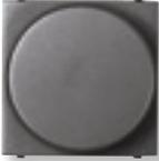
Regulador universal giratorio/pulsación. | N2260.2 BL<br>AN<br>PL | 230 V~ ; 50 Hz<br>☼ 60 - 500 W<br>⏏ 60 - 400 VA<br>⏏ 60 - 500 VA<br>Permite controlar la regulación de forma giratoria y por pulsación. Borna de control remoto para pulsadores auxiliares (N2X04.5). |
