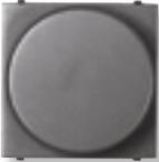
Regulador giratorio para fluorescentes   | N2260.9 BL<br>AN<br>PL | 230 V~ ; 50 Hz<br>↔ 700 VA<br>Válido para fluorescentes con balasto electrónico regulable.<br>Tension de control: 1 - 10 V DC<br>Corriente max. de control del balasto: 50 mA DC.                     |
