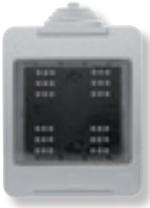
Caja 2 módulos  | N3291  | Cajas para instalación en superficie.<br>Color Gris, RAL 7035.<br>Entradas con cono multidímetro para tubo/cable de máximo Ø 20.<br>Se suministra sin mecanismos.<br>Con tapa que permite el accionamiento de los mecanismos directamente, de ángulo de apertura: 120°.<br>Cajas de doble aislamiento con cierre hermético. |
