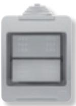
Pulsador estanco               | N3204  | Cajas para instalación en superficie.<br>Caja estanca.<br>Color Gris, RAL 7035.<br>Incluye mecanismo N2204.7, RAL 9010, 16 A ; 250 V.<br>Sin grabado.<br>Con tapa que permite el accionamiento de los mecanismos directamente, de ángulo de apertura: 120°.<br>Cajas de doble aislamiento con cierre hermético. |
