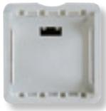
Soporte 2 módulos para carril DIN | N2692 BL | Según EN 50022.<br>Blanco RAL 9010.<br>Ancho 53,5 mm.<br>Para el montaje de mecanismos Zenit sobre perfil DIN en cuadros eléctricos. |
