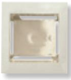
Zócalo de 2 módulos con marco incorporado | N2991.1 BL | Para 2 mecanismos de 1 módulo ó 1 de 2 módulos.<br>Entradas precortadas en los 4 lados para adaptadores N2999 y en 2 lados para los siguientes adaptadores unex y canaletas:<br>- 78672 (10 x 22)<br>- 78673 (10 x 30)<br>- 78681 (16 x 16):<br>Medidas:<br>(Ancho x Alto x Fondo):<br>64 x 70 x 47 mm. |
