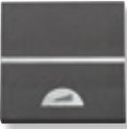
Regulador electrónico de pulsación. | N2260 BL<br>AN<br>PL   | 230 V~ ; 50 Hz<br>127 V~ ; 60 Hz<br>☼ 40 - 450 W<br>⏏ 40 - 400 VA.<br>Con borna de control remoto para pulsadores convencionales (N2X04.5) y visor de orientación nocturna. |
