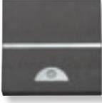
Interruptor temporizado | N2262 BL<br>AN<br>PL   | 230 V~ ; 50 Hz<br>☼ 1000 W<br>⏏ 1000 VA $\cos \varphi = 0,6$<br>↔ 650 VA<br>Temporizador:<br>10 seg. a 10 min.<br>Protección fusible T5A<br>Con borna de control remoto para pulsadores convencionales (N2X04.5) y visor de orientación nocturna. |
