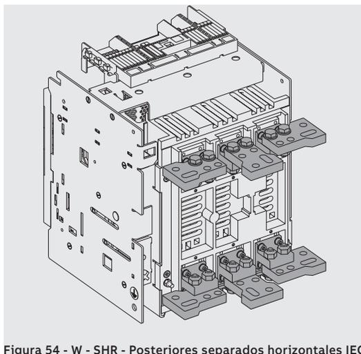
Figura 54 - W - SHR - Posteriores separados horizontales IEC
