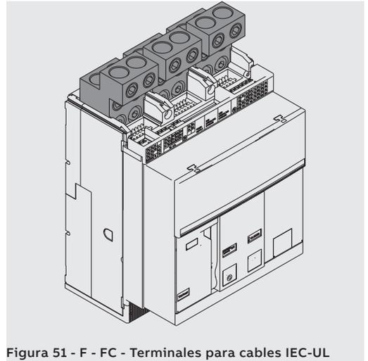
Figura 51 - F - FC - Terminales para cables IEC-UL
