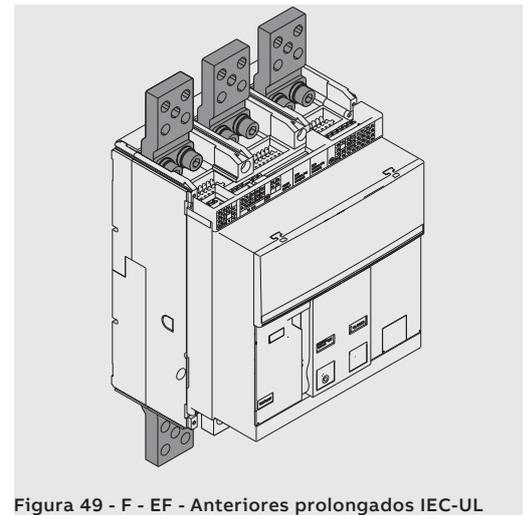
Figura 49 - F - EF - Anteriores prolongados IEC-UL
