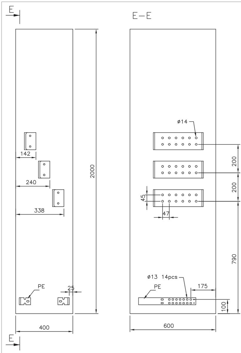
**Cubicle width 400 mm, top cable exit**
