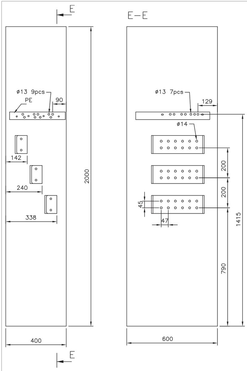
**Cubicle width 600 mm, bottom cable exit**
